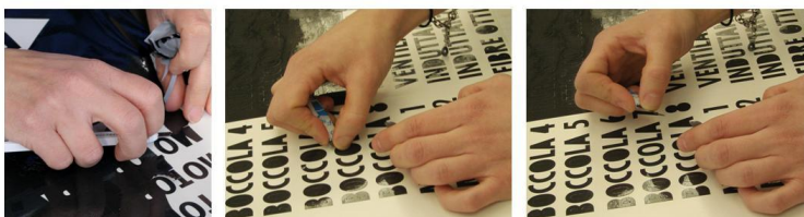
Figura 19: Processo di sfridatura interna, Fonte: Esanastri
